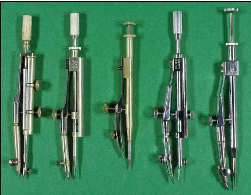
Evolution du mécanisme d'articulation des compas RIEFLER, au centre et à droite, système de centrage équipant les "round system" chromés.
