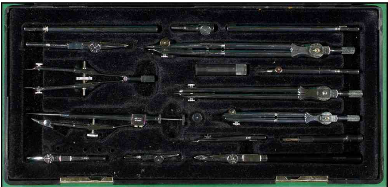
Boîte de compas RIEFLER "round type" chromés A52, boîte plus récente en plastique moulé (28,5x13x2,5 cm), cette boîte comporte deux rallonges ainsi qu'un adaptateur pouvant recevoir des accessoires de la série "plate" ou fabriqués par des concurrents.
