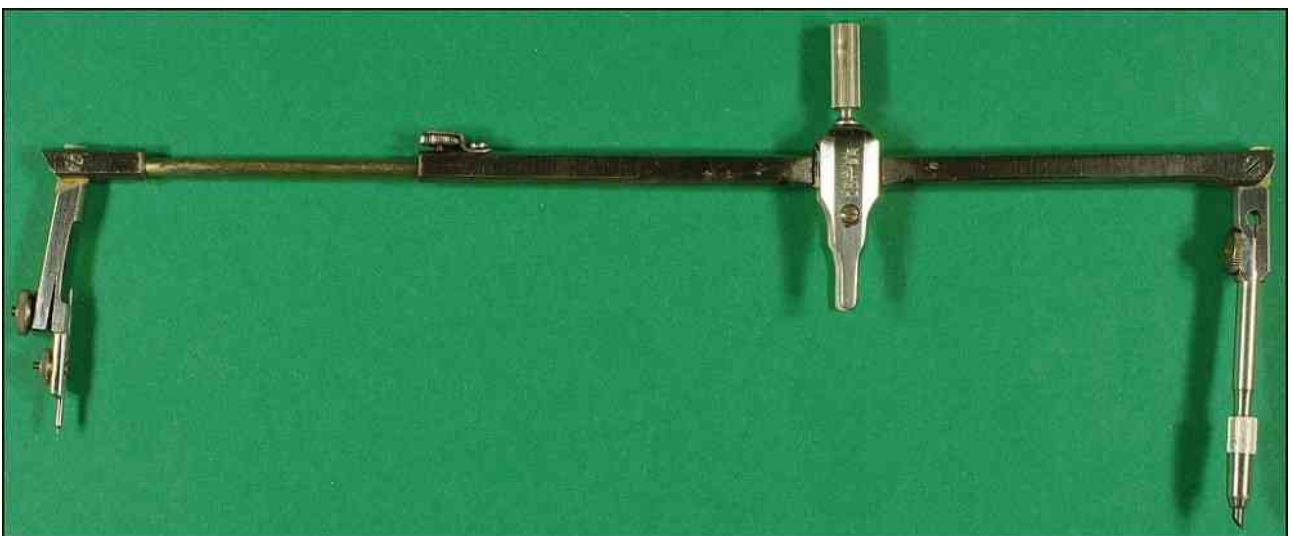
Compas Original Lotter à bras télescopique, le réglage fin de la pointe utilise le montage "Leg of hair divider", bras télescopique déployé.
