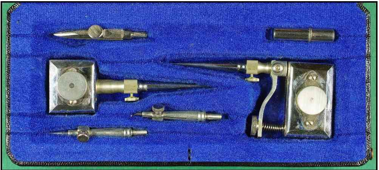
Un autre compas à verge RIEFFLER. Il se monte sur une règle plate.
