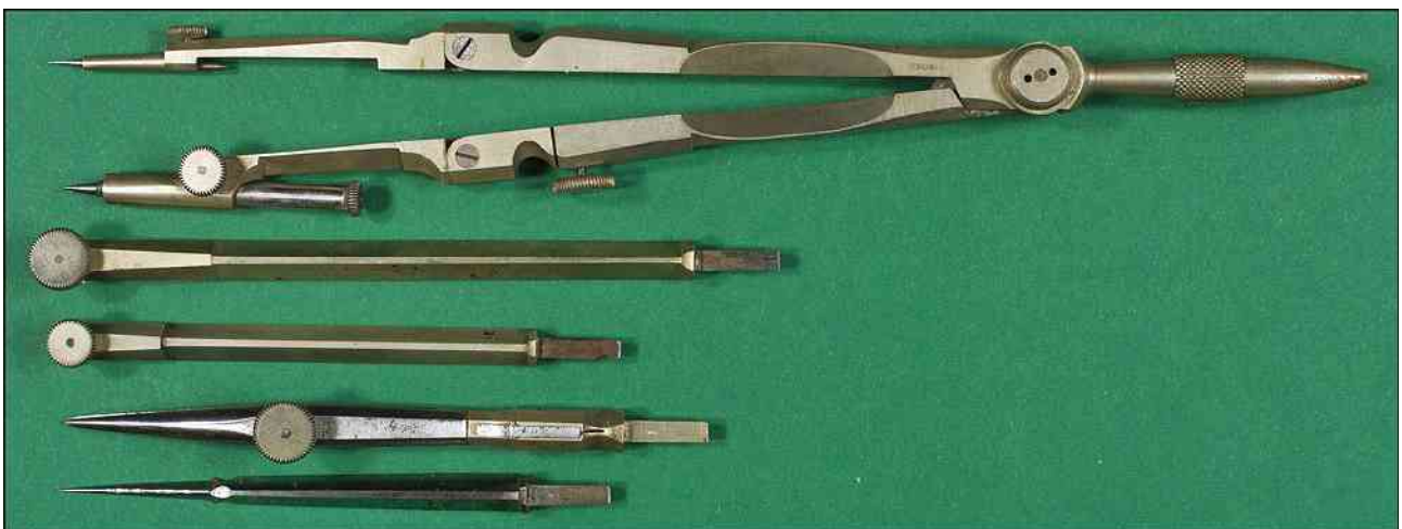
Pour comparaison : Grand compas MORIN de la même époque, avec ses accessoires. Longueur totale : 210 mm, la tête mesure 44 mm.
