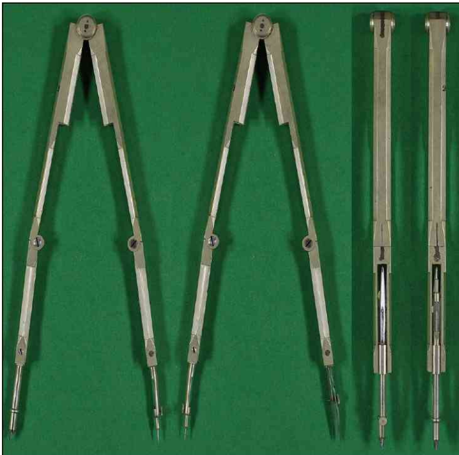
Un autre compas pliant caractérisé par sa longueur moins usuelle. Longueur plié 119 mm, déplié 210 mm.
