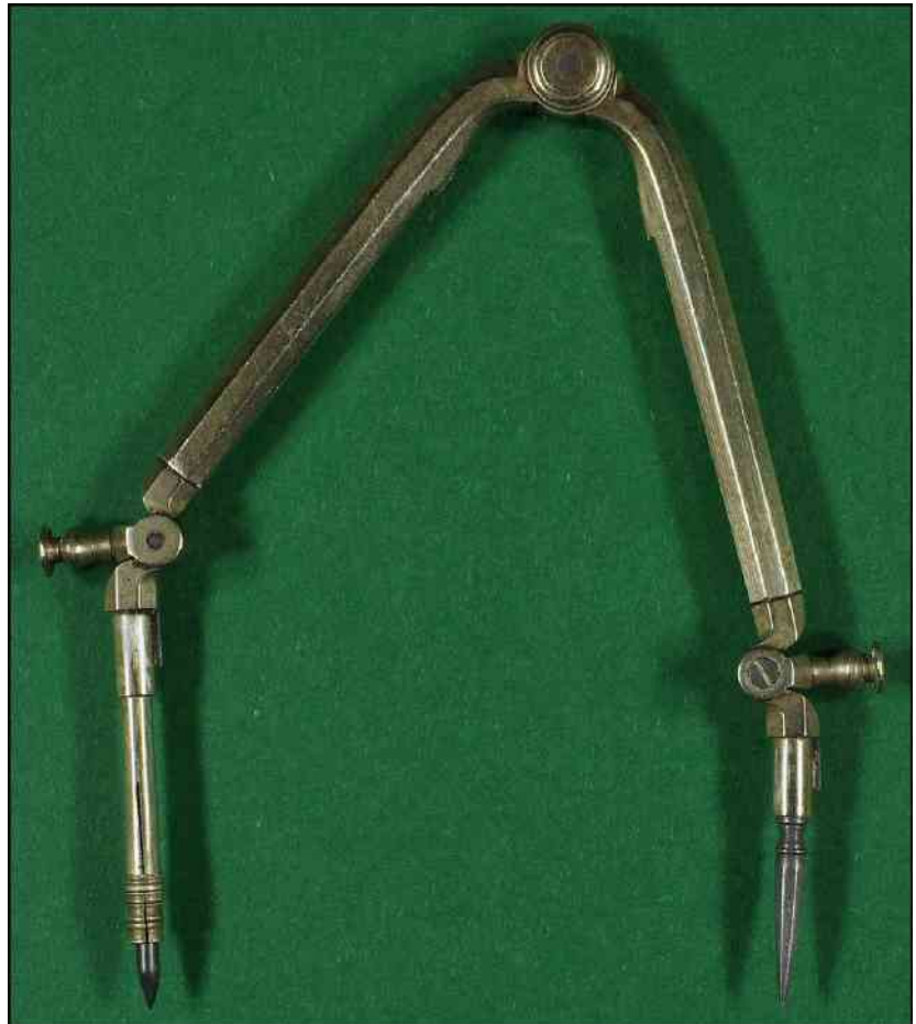
Compas pliant de type "Pillar", modèle asymétrique, longueur plié 80 mm, déplié 114 mm (avec deux pointes sèches), à remarquer, vis papillon sur le tire-ligne.
