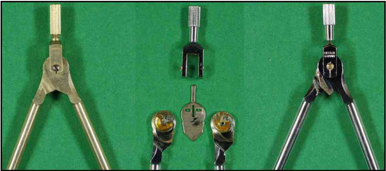
Evolution du mécanisme d'articulation des compas RIEFLER, au centre et à droite, système de centrage équipant les "round system" chromés.
