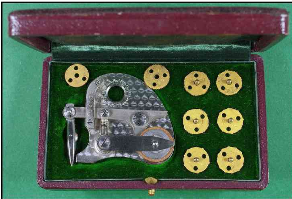
Pointilleur français ATELIERS PAUL HENRY, monté sur une plaque de mailchort épaisse (2,5 mm), il se caractérise notamment par une roulette lisse en fibre, 8 rouelles dont une lisse, permettant de l'utiliser comme un tire-ligne, une découpe permettant de le tenir facilement entre le pouce et l'index.
