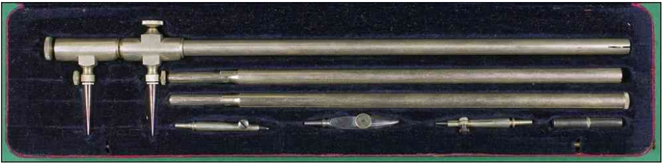
Compas à verge RIEFFLER de style rond. La verge est démontable en trois parties.
