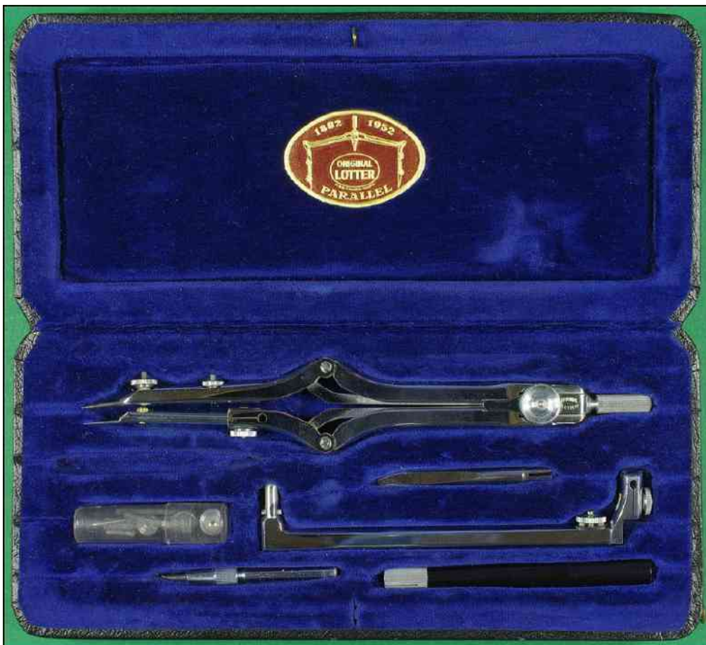
Un autre modèle du compas Original Lotter à double bras à parallélogrammes, il diffère de la première version par l'abandon du système "Leg of hair divider" de réglage fin de la pointe et son remplacement par le système "Mikrometer" à aiguille courbe élastique et déformable. Une étiquette célébrant les 70 ans de ce fabricant figure dans l'étui, elle permet de le dater de vers 1952.
