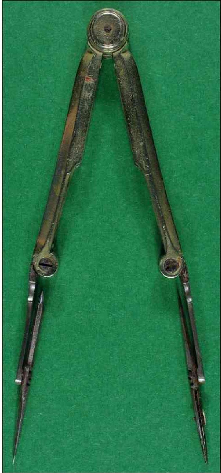
Compas pliant anglais de type "Napier", longueur plié 70 mm, déplié 118 mm.
