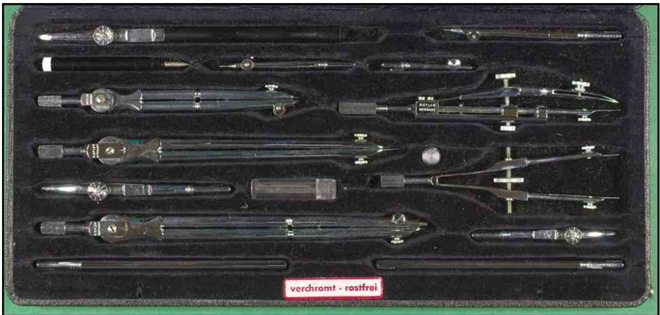
Boîte de compas RIEFLER "round type" chromés A52 premier modèle (26x12x2,5 cm), cette boîte comporte deux rallonges.
