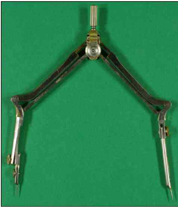
Compas Original Lotter à double bras à parallélogrammes, sans et avec sa rallonge, le réglage fin de la pointe utilise le montage "Leg of hair divider".
