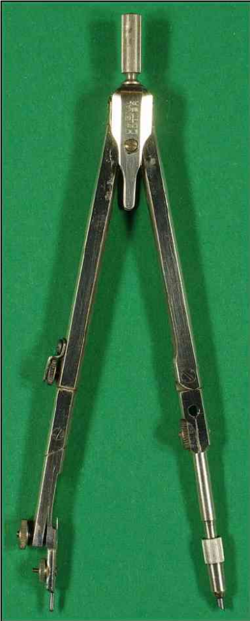
Compas Original Lotter à bras télescopique, le réglage fin de la pointe utilise le montage "Leg of hair divider".
