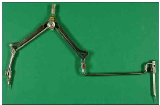
Compas Original Lotter à double bras à parallélogrammes, sans et avec sa rallonge, le réglage fin de la pointe utilise le montage "Leg of hair divider".
