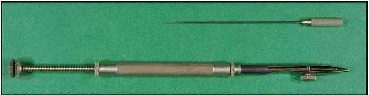
Tire-ligne à réservoir RIEFLER avec son aiguille de débouchage.
