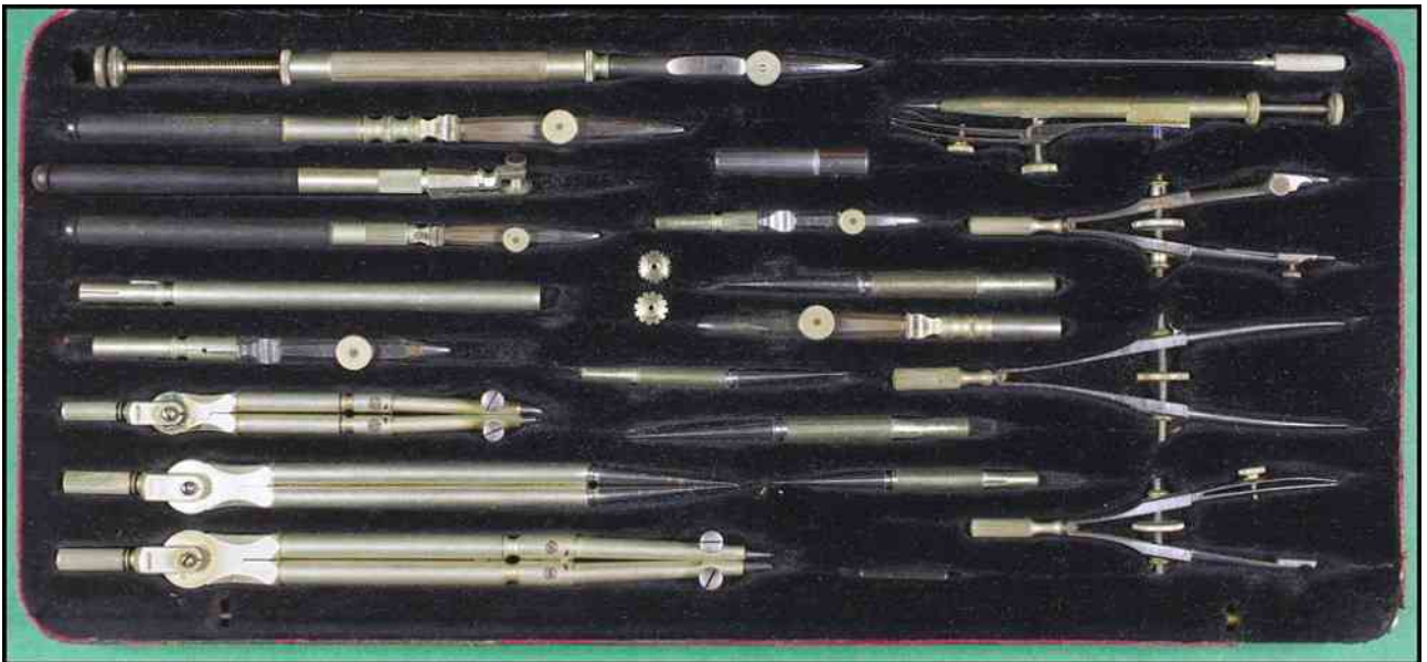
Boîte de compas RIEFLER "round type", cette boîte comporte en particulier un tire-ligne à réservoir et un pointilleur. (31x14x3,5 cm)
